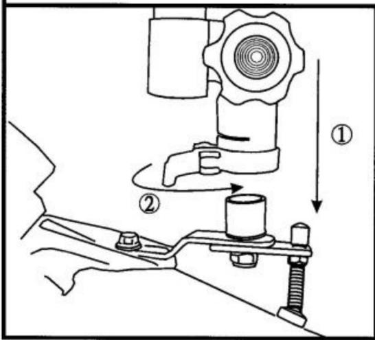
Während der Fahrt empfehlen wir, Halter und Sitz so einzustellen, dass die Teleskopstange fest an den Sitz gedrückt wird, so dass eine zusätzliche Standfestigkeit erreicht wird.
