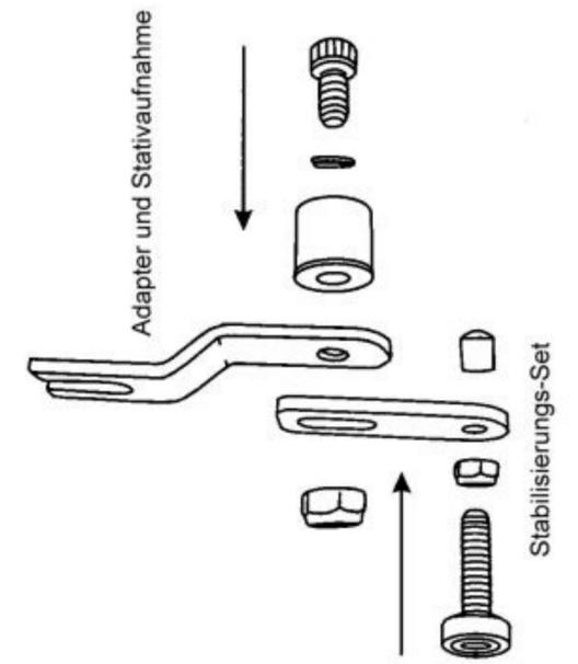
Das Stabilisierungs-Set erlaubt eine Vibrationsarme Befestigung des Trägers. Bitte folgen Sie der Anleitung.
