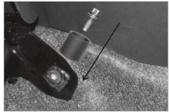
1. Lösen Sie die Schraube des Beifahrersitzes und befestigen Sie dort die Stativaufnahme. Falls der Halter in dieser Position nicht eingesetzt werden kann, gehen Sie gemäß A + B weiter vor.
