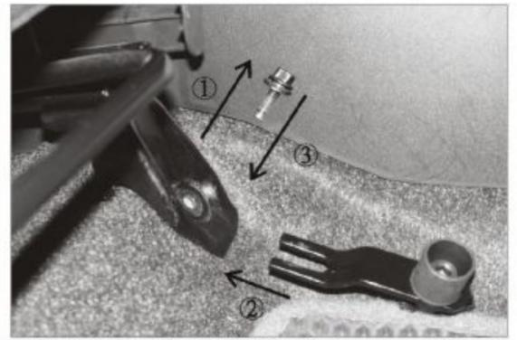
B) Befestigen Sie die Stativaufnahme samt Adapter und Stabilisierungs-Set am Sitz.
